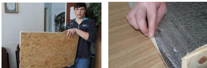
Рис 3 Прикрепил к основе OSB фольгу
