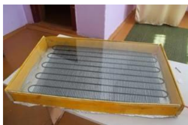
Рис 5 Прикрепил трубчатые жгуты к змеевику, вывел их в отверстия рейки и накрыл стеклом
