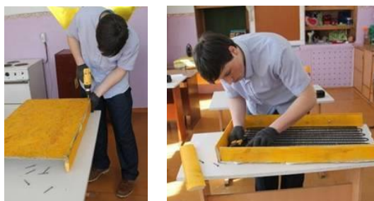
Рис 4 Прикрепил рейки и змеевик на 1 см от основы
