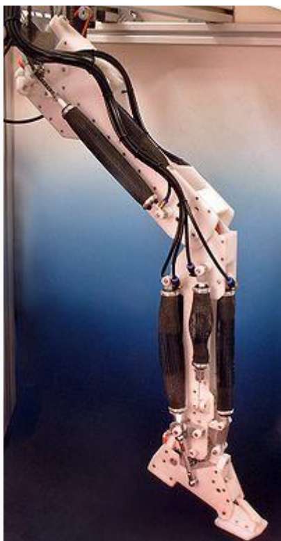
Нога робота, работающая на воздушных мышцах.
