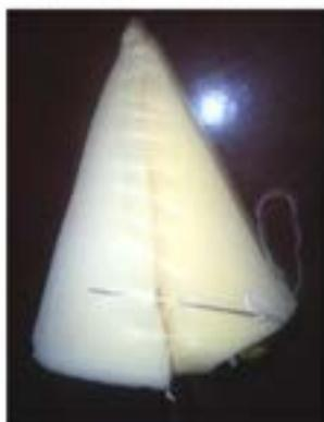
3. Сворачивание поролона в конус и сшивание для придания формы.
