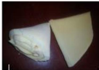
2. Заготовки из поролона. Заполнение внутренней части поролоном для уплотнения формы.
