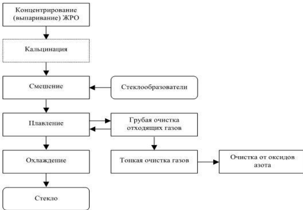
Рис.2. Принципиальная схема технологии остекловывания жидких радиоактивных отходов.
