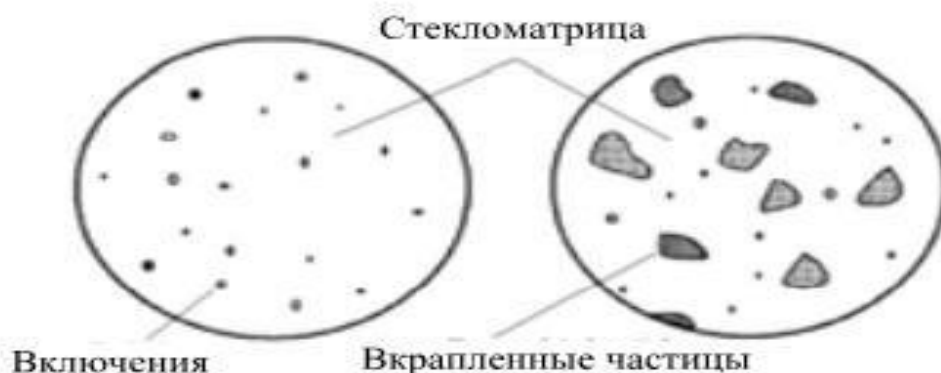
Рис. 1. Механизмы включения радионуклидов в остеклованном продукте. Слева – относительно однородный стеклопродукт фиксирует радионуклиды в структуру стекла. Справа – радионуклиды содержатся во включениях.
