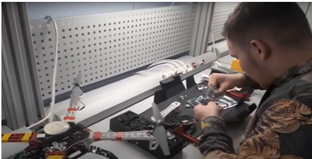
Рисунок 3. Сборка экспериментального БПЛА с подвесной IP-камерой на основе конструктора DJI F450
