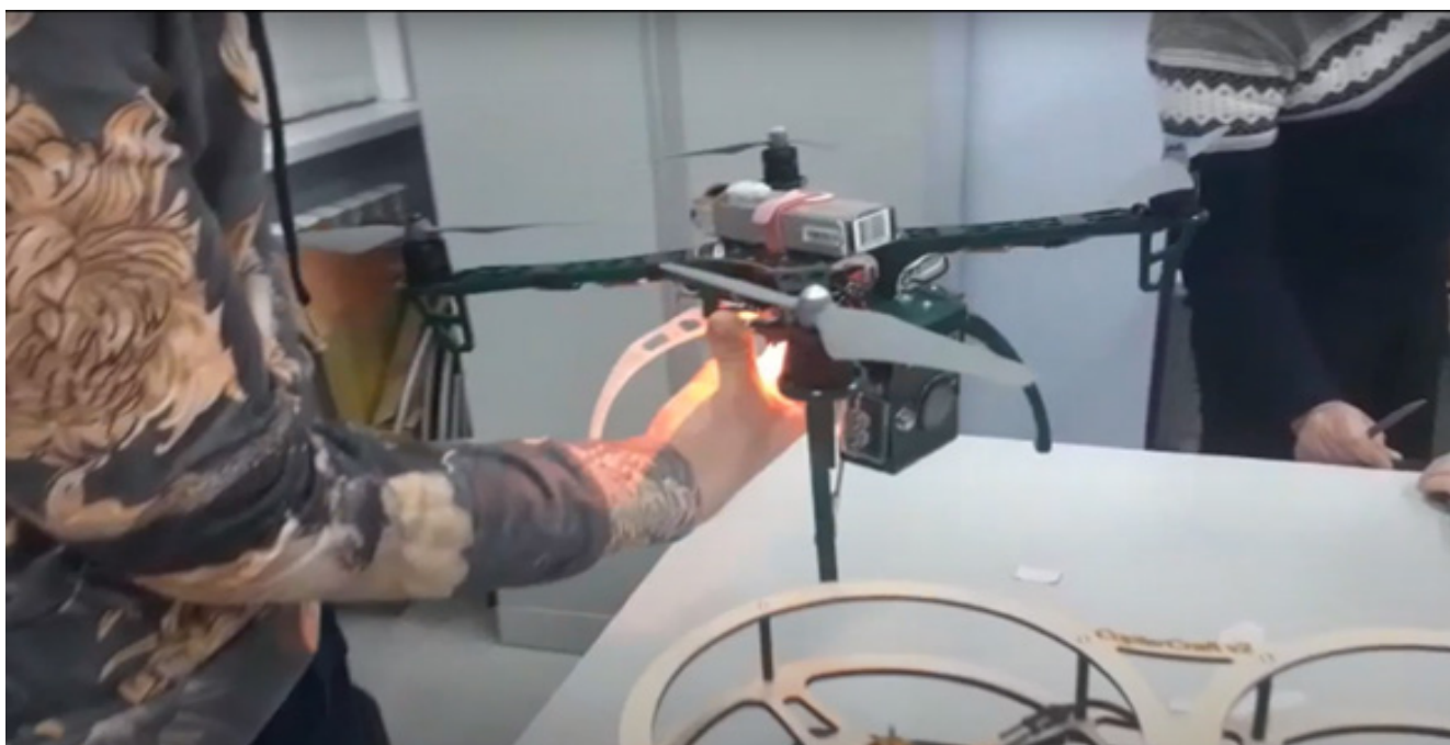
Рисунок 3. Сборка экспериментального БПЛА с подвесной IP-камерой на основе конструктора DJI F450
